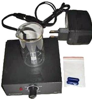
**Магнитная мешалка МУЛЬТИТЕСТ ПС-11** предназначена для перемешивания жидкостей в лабораторных условиях.
