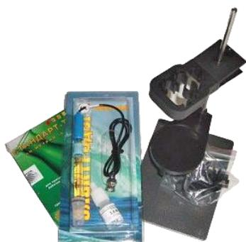
**Комплект для определения pH** предназначен для определения активности ионов водорода (водородного показателя) pH. Может использоваться со всеми приборами серии МУЛЬТИТЕСТ ИПЛ.
