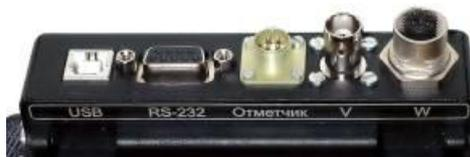
В состав функций прибора "Тест-СК" входит регистрация и анализ спектров вибросигналов на электродвигателе и редукторе станка-качалки. Одноканальный анализатор вибросигналов, необходимый для этого, расположен в корпусе прибора "Тест-СК". Это позволяет диагностировать подшипники качения двигателя и редуктора СК.
