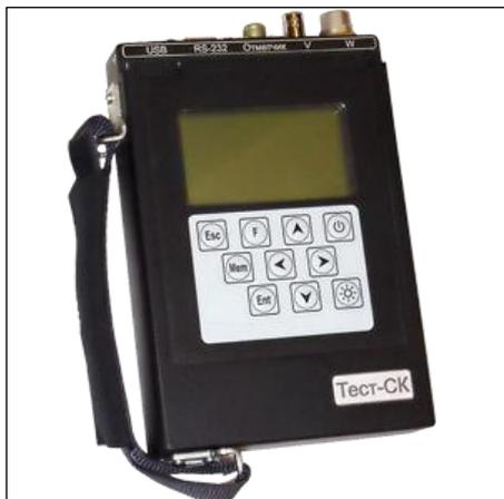
Прибор "Тест-СК" предназначен для проведения диагностики технического состояния оборудования станков-качалок и проведения диагностики состояния и балансировки вращающегося оборудования.
