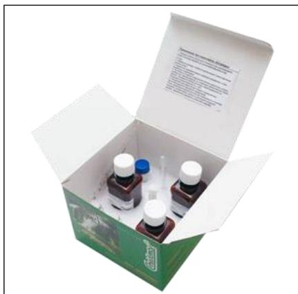
Тест-комплект Хлориды предназначен для экспресс-определения массовой концентрации хлорид-ионов в питьевой, природной и нормативно-очищенной сточной воде (МИ-02-144-09).
