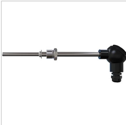
Термопары с коммутационной головкой ДТПХхх5 предназначены для температурных измерений твердых, жидких и газообразных сред. Позволяют проводить измерения достаточно высоких температур — до 900°C. Присоединение термопар хх5 к измерительной линии производится термопарным кабелем (кабель в комплекте не поставляется, заказывается отдельно).
