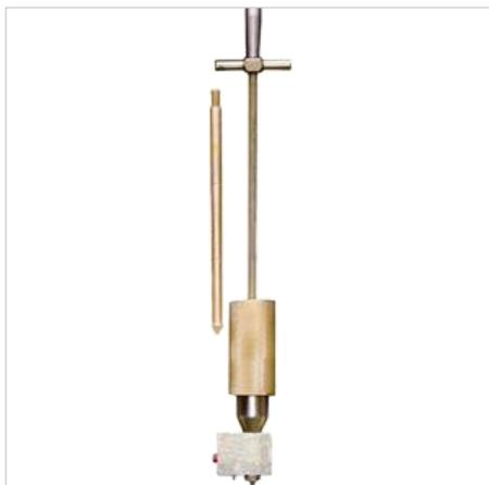
Универсальный динамический плотномер ДПУ предназначен для текущего контроля качества уплотнения грунтов земляного полотна и дополнительных слоев оснований автомобильных дорог, аэродромов и прочих земляных сооружений.
