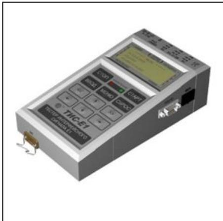
Измерительный прибор ТИС-Е1 предназначен для обслуживания, настройки и наладки цифровых систем передачи PDH и SDH, имеющих стык Е1 со скоростью 2,048 Мбит/с. Измерительный прибор включает в себя генератор и анализатор тестовых сигналов и позволяет проводить измерения без перерыва связи, с перерывом связи по шлейфу или по направлению.
