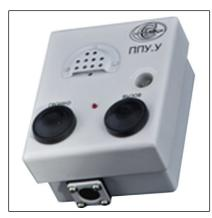
Парковое переговорное устройство упрощенное ППУ.У предназначено для ведения переговоров и передачи громкоговорящих оповещений при работе в составе аппаратуры двухсторонней парковой связи.
