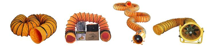
Промышленные гибкие воздуховоды предназначены для подключения к вентиляторам серии SHT диаметром от 200 до 600 мм и длиной 10 м (диаметр воздуховода подбирается в соответствии с диаметром патрубка вентилятора).
