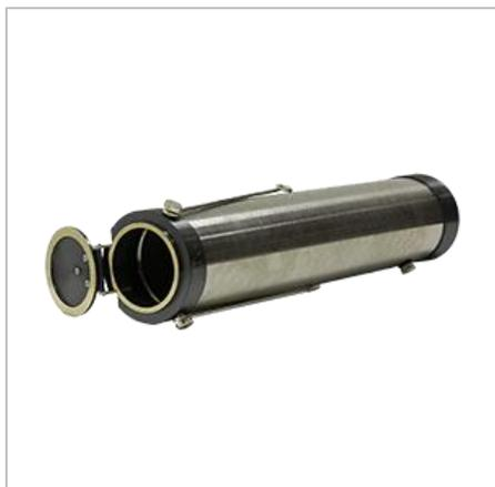
Батометр Паталаса предназначен для взятия проб воды со взвешенными наносами.
