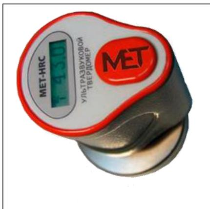
Ультразвуковые миниатюрные твердомеры МЕТ-мини проводят контроль твердости только по одной шкале и выпускаются в модификациях МЕТ-HRC, МЕТ-HB, МЕТ-HV и МЕТ-HSD. Твердомеры предназначены для измерения твердости металлических изделий соответственно по шкале Роквелла, Бринелля, Виккерса и Шора при нагрузке 15 Н (1.5 кгс) или 50Н (5 кгс).
