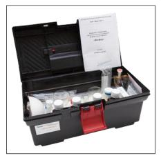
Комплектная лаборатория Фосфор предназначена для количественного определения в воде фосфора во всех его формах: ортофосфов (суммарной концентрации анионов  $PO4^{3-}$ ,  $HPO4^{2-}$ ,  $H2PO4^{-}$ , а также свободной H3PO4), гидролизующихся и негидролизующихся полифосфатов, органических фосфатов (эфиров фосфорной кислоты), а также «общего фосфора».
