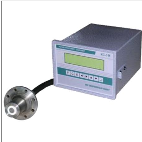
Прибор предназначен для непрерывного мониторинга удельной электрической проводимости (УЭП) и температуры жидких сред с последующим преобразованием в значение концентрации вещества в соответствие с заранее заданной зависимостью. Датчик прибора с плоскими электродами, непосредственно врезается в трубопровод, либо стенку сосуда, не создавая помех потоку жидкости.
