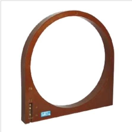
Датчик тока трансформаторный ТДЗЛВ-10 в комплекте с устройством УСЗ-ЗС предназначен для поиска поврежденной воздушной линии электропередачи напряжением 6-10 кВ (СП ВЛ-1Ф) с однофазным замыканием в сети с изолированной и компенсированной нейтралью.
