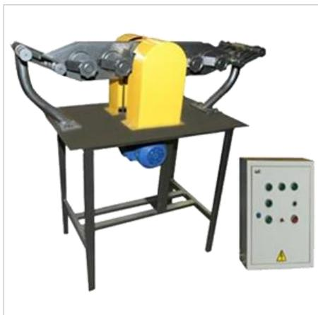
Вибрационный истритель ИВС-4 предназначен для доистирания проб в периодическом режиме сухим способом.
