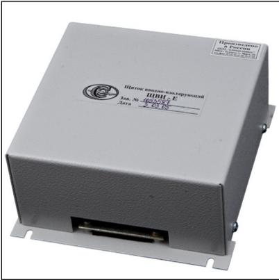
Щиток вводно-изолирующий **ЩВИ-Е** предназначен для защиты от грозовых разрядов и опасных перенапряжений аппаратуры промежуточных пунктов поездной диспетчерской и станционной связи на участках железных дорог, электрифицированных на переменном токе.
