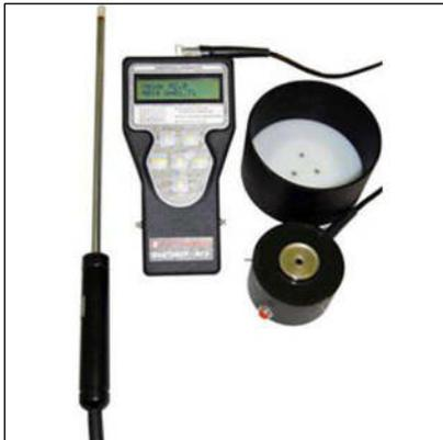
Измеритель влажности строительных материалов (влагомер) «МГ4» предназначен для оперативного контроля влажности древесины по ГОСТ 16588 и широкой номенклатуры строительных материалов, в том числе в изделиях, конструкциях и сооружениях по ГОСТ 21718.
