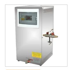
Электрический аквадистиллятор АЭ-10/20 предназначен для производства дистиллированной воды из исходной путем её нагрева до кипения с дальнейшей конденсацией водяного пара и получением дистиллята с температурой в пределах от +40°C до +85°C с последующим его накоплением во встроенном баке-накопителе.
