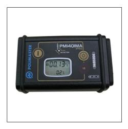
Измеритель-сигнализатор поисковый ИСП-РМ1401МА - это высокочувствительный компактный поисковый прибор, предназначенный для обнаружения и локализации радиоактивных материалов. В приборе предусмотрены два режима работы: поиск радиоактивных источников по их внешнему гамма излучению и оценка уровня излучения в мкЗв/ч (по линии <sup>137</sup>Cs в коллимированном излучении).
