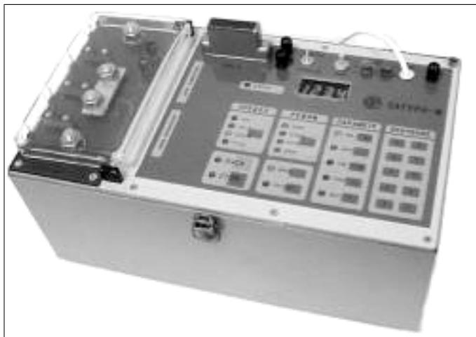
Испытательные устройства "Сатурн-М", "Сатурн-М1" предназначены для проверки и настройки автоматических выключателей с тепловыми и электромагнитными расцепителями присоединений 220-380 В частоты 50 Гц, а также для проверки характеристик средств релейной защиты присоединений 6-35 кВ и оценки тока короткого замыкания (КЗ) цепи фаза-нуль присоединений 380 В и тока КЗ на шинах 380 В.
