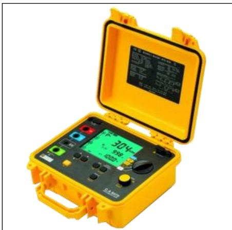
Прибор С.А 6470N объединяет в себе три прибора, поскольку предназначен для оценки действующих устройств заземления, определения наилучшего положения новых электродов заземления и проверки электрических соединений.
