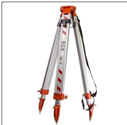
Штатив универсальный **RGK S8-P** подходит для любых по весу геодезических приборов благодаря диаметру площадки, толстым стенкам алюминия и двойному виду зажимов (вверху – клипса, внизу - винт).
