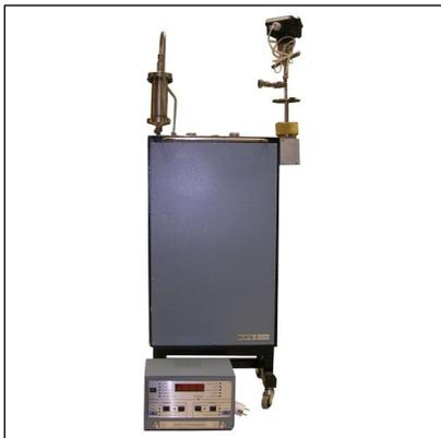
Аппарат **ИПБ-1** предназначен для автоматизированного определения индукционного периода бензинов по методам ГОСТ 4039, ГОСТ Р ИСО 7536 и ASTM D525.
