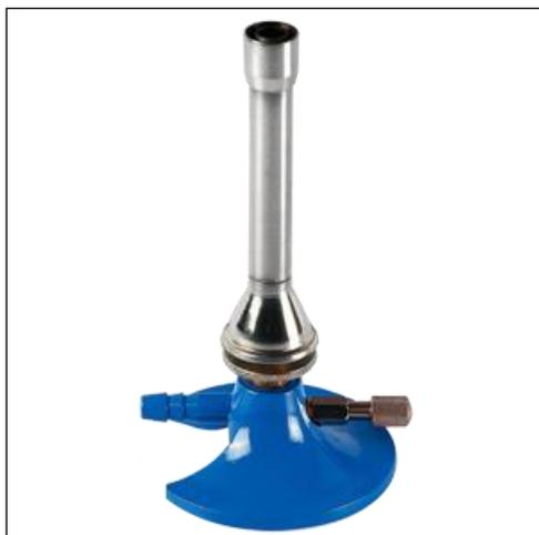
Газовая Горелка Теклю предназначена для нагрева материалов открытым узким высоким пламенем с максимальной тепловой мощностью не более 1220 Вт.
