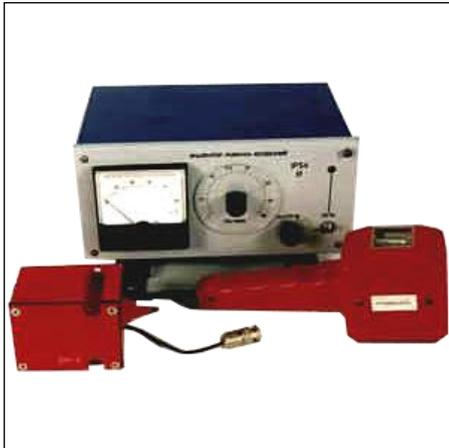
Индикаторы электронные ВБВ-005 и ВБВ-007 предназначены для индикации виброперемещения вращающихся деталей (роторов) при наличии у последних неуравновешенности масс.
