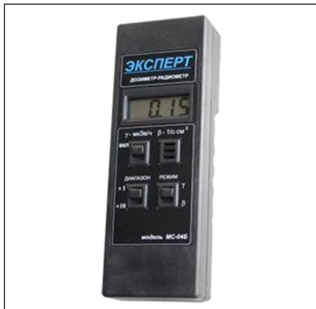
Предназначен для определения мощности эквивалентной дозы фотонного (гамма) излучения и плотности потока бета-излучения от загрязненных поверхностей в быту, на производстве и в банковской сфере.
