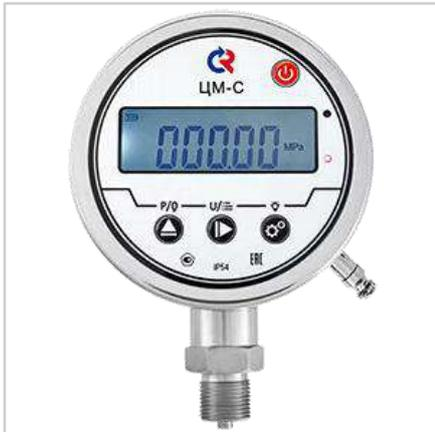
Цифровые манометры с аналоговым выходным сигналом типа ЦМ-С (модификации ЦМ-С-И, ЦМ-С-В, ЦМ-С-ИВ) предназначены для непрерывного измерения и отображения текущего значения с индикацией на цифровом ЖК-дисплее давления жидкостей и газов, разрежения газов, неагрессивных по отношению к нержавеющей стали, а также передачи данных в системы управления и контроля. Манометры типа ЦМ-С изготавливаются в соответствии с НСРП.421262.020 ТУ.
