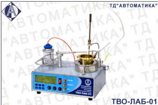
Полуавтоматический аппарат «ТВО-ЛАБ-01» предназначен для определения температуры вспышки в открытом тигле по методу Кливленда в соответствии с ГОСТ 4333-87, ISO 2592, ASTM D 92. ТВО ЛАБ 01 это экономичная альтернатива полностью автоматическим анализаторам с простотой и удобством проведения измерений по сравнению с ручными аппаратами.
