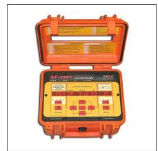
Генератор АГ-120Т предназначен для локализации и диагностики подземных коммуникаций (кабели, трубопроводы). Максимальная мощность генератора от 120 Вт до 270 Вт (в зависимости от выбранных режимов работы).
