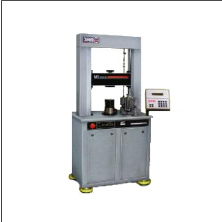
Позволяет определять предел прочности материала при сжатии по ГОСТ 12801. Возможно проведение испытаний других материалов в пределах технической характеристики машины. Устанавливается на виброопорах, специальный фундамент не требуется.
