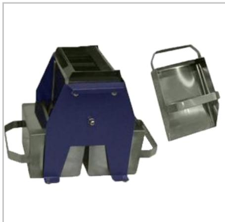
СЖ делители проб используются для разделения проб сухих материалов, а также пульпы и суспензий.
