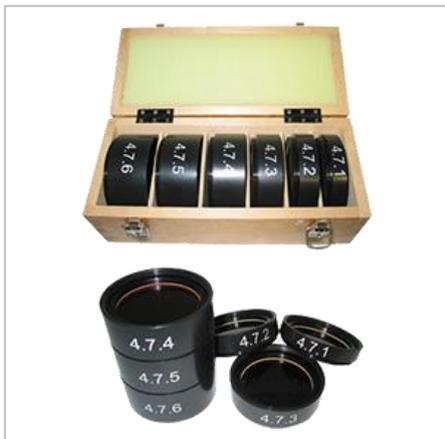
КНО-4 предназначен для проверки извещателей охранных линейных оптико-электронных (по ГОСТ 27990).
