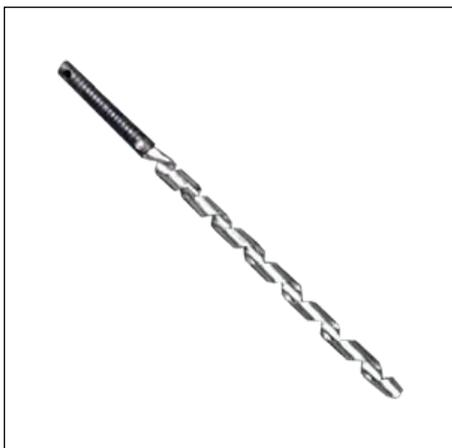
Винтообразный щуп ЩВ предназначен для отбора мазеобразных нефтепродуктов из бочек, бидонов, барабанов, банок и др. Щуп (бур) опускают, ввинчивая в нефтепродукт, до дна тары, затем извлекают и лопаточкой снимают с него пробу.
