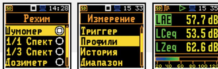
Режим дозиметра. Если режим шумомер предназначен для измерения и оценки энергии звуковых волн, распространяющихся в окружающей среде, то режим ДОЗИМЕТР предназначен для измерения и оценки субъективных ощущений человека на воздействие звуковой энергии.
