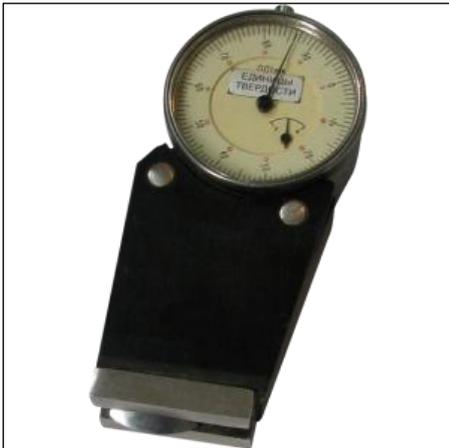
Твердомер модель 04421 для сухих форм и стержней производится для измерения поверхностей твердости сухих форм и стержней.
