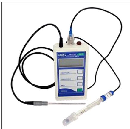
Переносной рН-метр МАРК-901 предназначен для измерения активности ионов водорода (рН), ЭДС и температуры водных сред.
