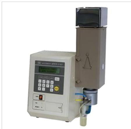
Фотометр ФПА-2-01 предназначен для измерения концентрации химических элементов в растворах путем фотометрических измерений пламени газовой горелки, в которое в распыленном виде вводится анализируемый раствор.
