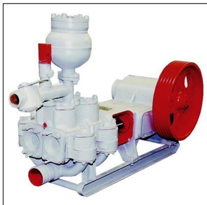
Буровые насосы **НБ-32, НБ-50, НБ-80** предназначены для нагнетания промывочной жидкости (воды, глинистого раствора) в скважину при геологоразведочном и структурно-поисковом бурении на нефть и газ.
