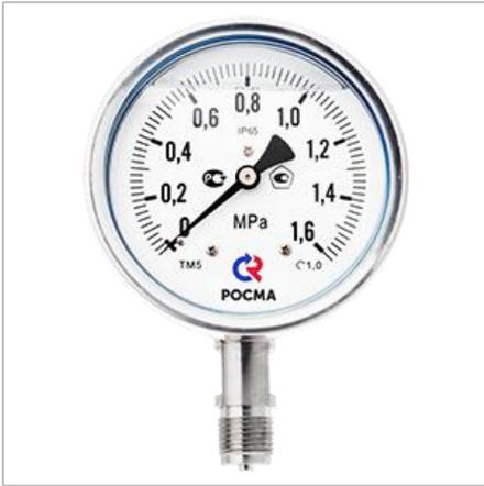
Манометры коррозионностойкие ТМ (ТВ, ТМВ) серии 21 выполнены полностью из нержавеющей стали. Применяются для измерения давления агрессивных жидких и газообразных, не вязких и не кристаллизующихся измеряемых сред с температурой до +200°С.
