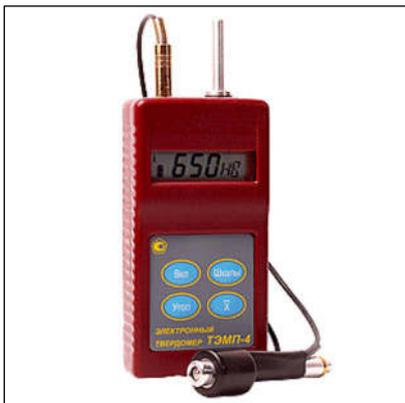
Портативный твердомер «ТЭМП-4» предназначен для экспрессного измерения твердости различных изделий (из стали, чугуна, цветных металлов, резины и др. материалов) в производственных и лабораторных условиях по шкалам Бринелля (HB), Роквелла (HRC), Виккерса (HV), Шора «D» (HSD).
