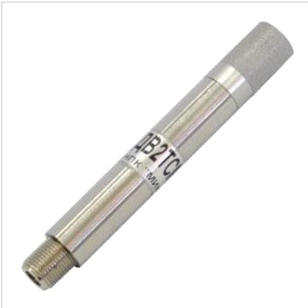
Измерительный преобразователь влажности и температуры ДВ2ТСМ-Б предназначен для непрерывного преобразования относительной влажности и температуры воздуха и газообразных сред в цифровой выходной сигнал по двухпроводному интерфейсу  $\mu$ ForLAN и протоколу MODBUS.
