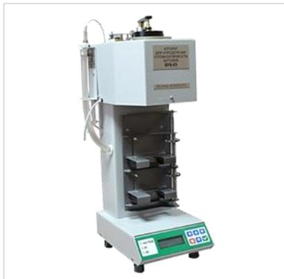
ВУБ-03 предназначен для определения условной вязкости нефтяных битумов путем измерения времени, в течение которого определенное количество битума протекает через калиброванное отверстие цилиндра при заданной температуре.
