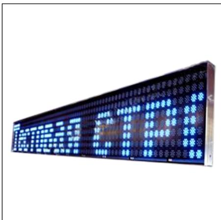
Бегущие светодиодные строки "Импульс" с высотой символов 500мм предназначены для отображения любой текстовой информации. Эксплуатация осуществляется в уличных условиях без дополнительной защиты корпуса.
