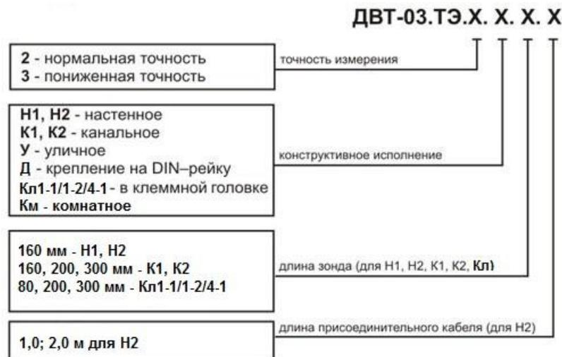
Не имеют индикатора, но имеют более широкий ряд конструктивных исполнений. В том числе вандалоустойчивые исполнения с клеммной головкой, а также исполнение для контроля влажности в чистых помещениях и офисах и исполнение на DIN-рейку для использования внутри шкафов управления.
