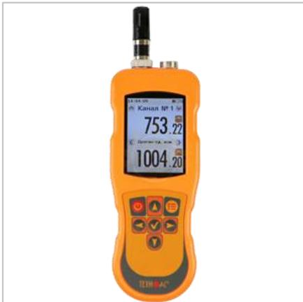
Термометры контактные ТК-5.29 предназначены для измерения температуры жидких, сыпучих, газообразных сред.
