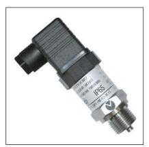
Датчики серии «ПД100-ДИ» предназначены для непрерывного преобразования избыточного давления измеряемой среды в унифицированный сигнал постоянного тока 4...20 мА.
