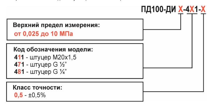
Датчики данной модели могут применяться в системах автоматизации и контроля технологических процессов, требующих повышенную точность измерений.
