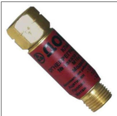
Когнепреградительный клапан «КОГ» предназначен для защиты кислородных и газовых рукавов от разрывов и возгорания при обратных ударах пламени. Клапан устанавливается на резак или горелку.
