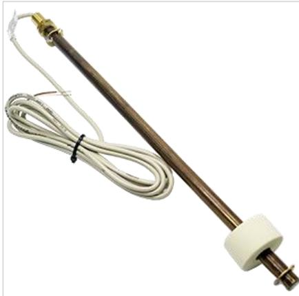
Поплавковые датчики уровня ВБУ-33 предназначены для контроля уровня жидкостей в резервуарах. Класс исполнения – IP68. Рабочая температура датчиков уровня – до 105 градусов по Цельсию.
