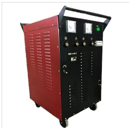
Сварочный выпрямитель – это сварочный аппарат, который состоит из силового трансформатора и выпрямительного блока, который преобразует переменный сварочный ток в постоянный ток.
