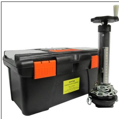
Аппаратура контроля опор деревянных **АКОД-М** является прибором неразрушающего контроля, предназначенным для определения степени загнивания деревянных опор линий электропередач.
