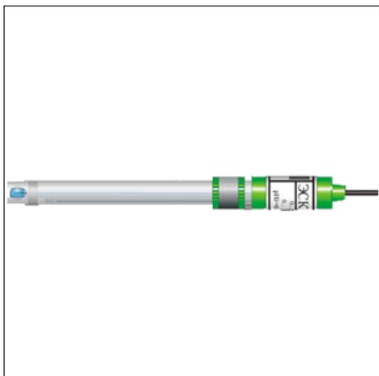
Предназначен для большинства случаев лабораторного анализа. Для измерений при повышенной температуре, а также анализа сильнощелочных растворов с высоким содержанием ионов Na<sup>+</sup>. Двухключевое исполнение встроенного электрода сравнения позволяет применять для его заполнения не только растворы KCl, но и другие электролиты в тех случаях, когда нежелательно попадание ионов K<sup>+</sup> и/или Cl<sup>-</sup> в анализируемый раствор.
